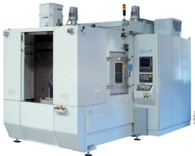
Die Hochdruckanlage hat Freiheitsgrade wie ein 4-Achs-Bearbeitungszentrum und kann automatisiert be- und entladen werden.
